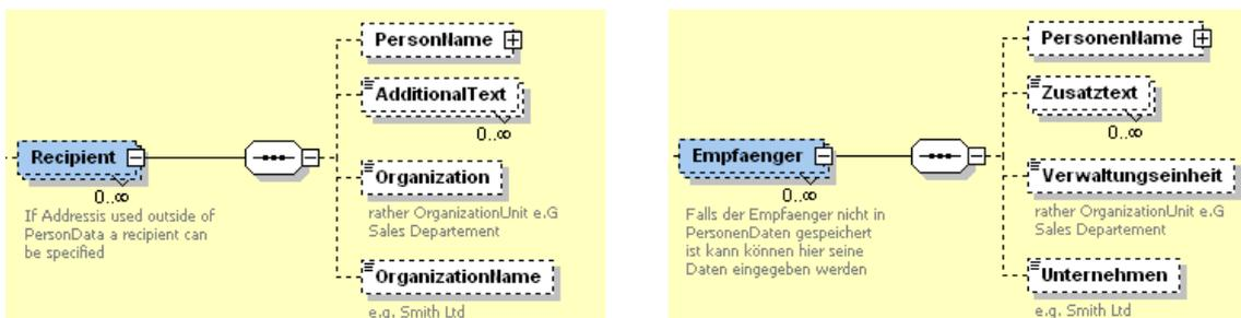
Abbildung 2.13: Unterlemente des Recipient und des Empfaenger Containers
