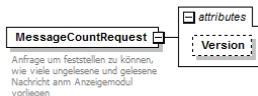
Abbildung 15 – Struktur des amod:MessageCountRequest Elements
